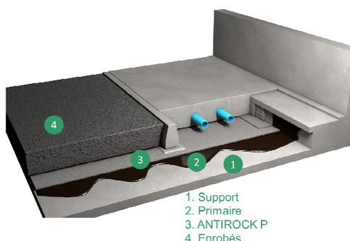
La mise en œuvre se fait par réchauffage. On chauffe alternativement le support imprégné de primaire et la feuille bitumineuse. Le soudage est réalisé : soit manuellement à la flamme vive, soit automatiquement à l'air chaud (système MACADEN).
